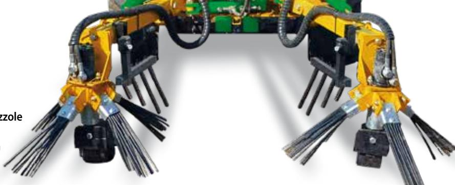
La spazzola è formata da elementi in plastica flessibile particolarmente idonei ad effettuare una pulizia soffice ma al tempo stesso energica, in grado di asportare, ramaglie, sarmenti, foglie e quant'altro concentrando il prodotto di scarto al centro del filare.
